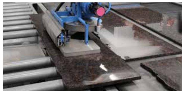
Rodding unit Rainurage inférieur Werkzeug für untere Rillen Corte inferior
