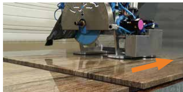
Moving the piece after cutting. Déplacement de la pièce après découpe. Bewegen des Werkstückes nach dem Schneiden. Movimiento de la pieza después del corte.
